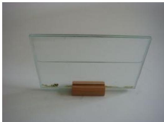
J'ai enfin trouvé un fournisseur de **mini-aquarium** pour faire les tests de toxicité aux artémias. Il est en verre collé au silicone et ses dimensions sont de 15 x10 cm. L'écartement entre lames est de deux millimètres (on peut au besoin le poser horizontalement sans que l'eau s'écoule). Le prix est de 5 € l'unité (sans le support) mais le fournisseur ne se charge pas de l'expédition. Si des spiruliniers sont intéressés je peux me charger d'en commander et de les amener à la
