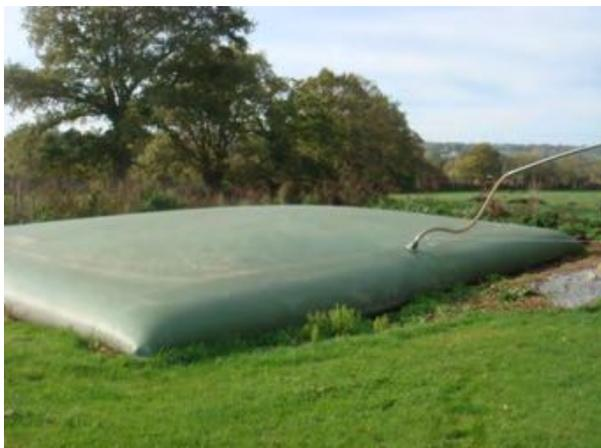
combustible riche en méthane et en CO<sub>2</sub> et un résidu qui est un bon engrais agricole. Le gaz alimente un moteur qui entraîne un alternateur fournissant de l'électricité vendue à l'EDF. Le refroidissement du moteur produit de la chaleur sous forme d'eau chaude à environ 80°C dont une partie sert à chauffer le digesteur et le reste est soit perdu (aéroréfrigérant) soit valorisé.
