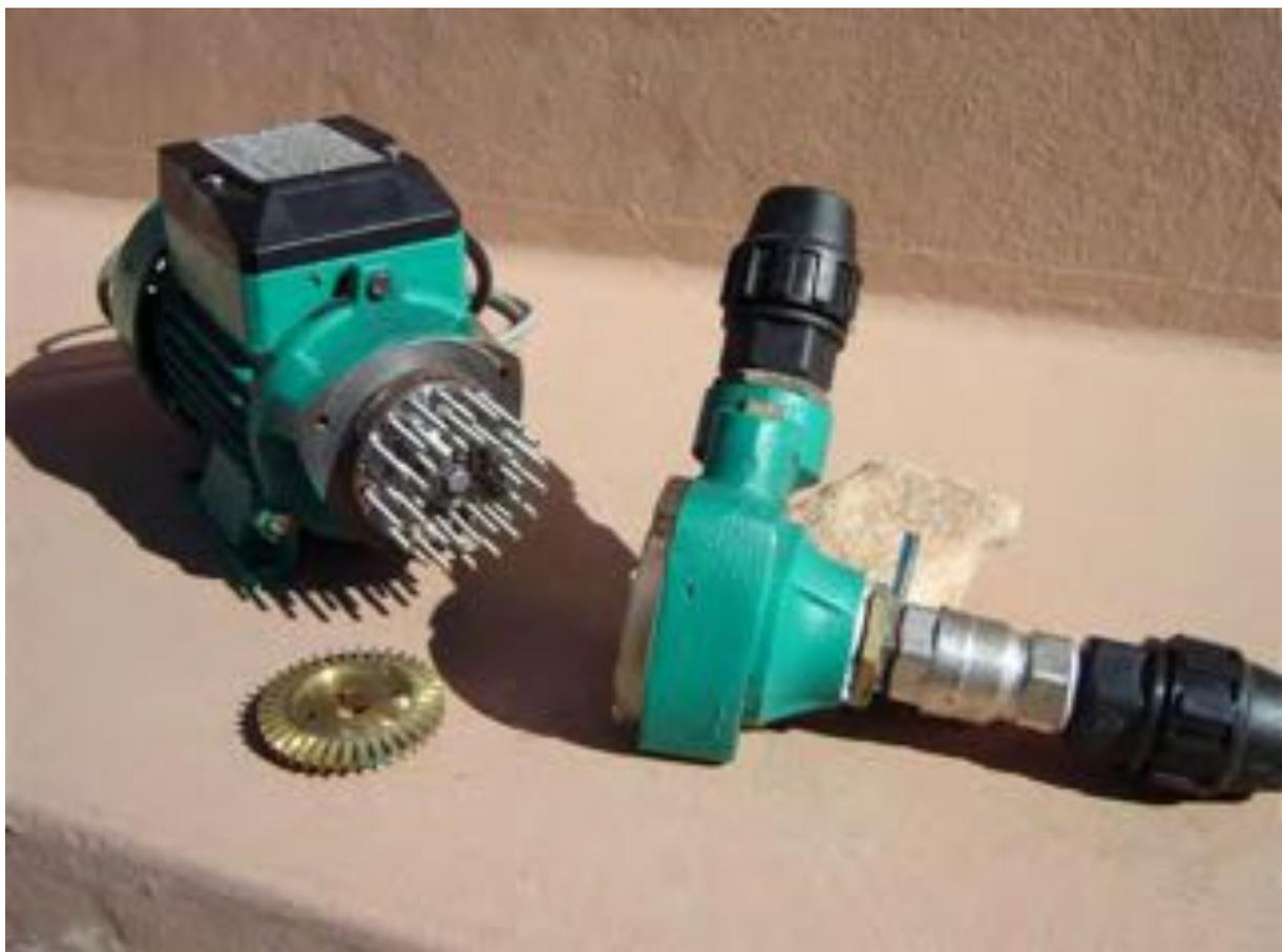
Ces émulsionneuses consomment peu d'énergie et fonctionnent presque à sec. Pour le moment on ne voit pas encore de dégâts dus à la cavitation. D'après l'expérience de Peter une puissance de 50 W suffit pour un bidon de 1000 litres.
