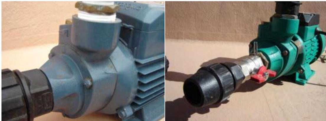
Peter modifie ces pompes en émulsionneuses en remplaçant le rotor par un disque portant une multitude de vis :
